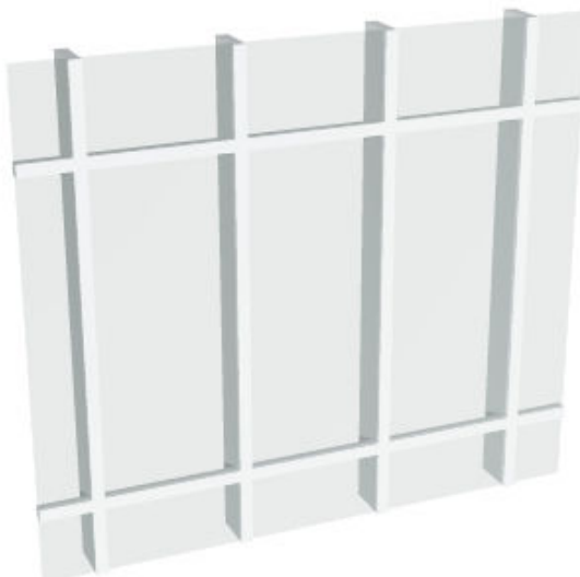
rys. Układ słupków i rygli fasady
